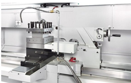
Fácil manipulación: para posicionamiento, el cabezal móvil se puede acoplar con el soporte
