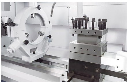
Cambiador de herramientas de 4 estaciones pesado y automático con servomotor para cambios de herramientas programados
